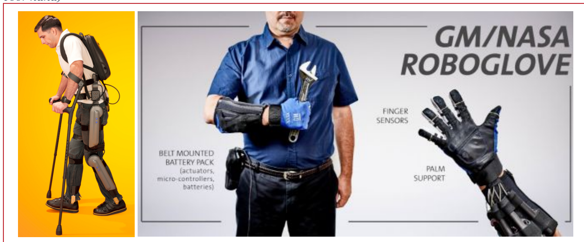
Figuur 15 Voorbeelden van gemotoriseerde exoskeletten (links: ReWalk voor onderlichaam, rechts: Robo-Glove voor hand)
